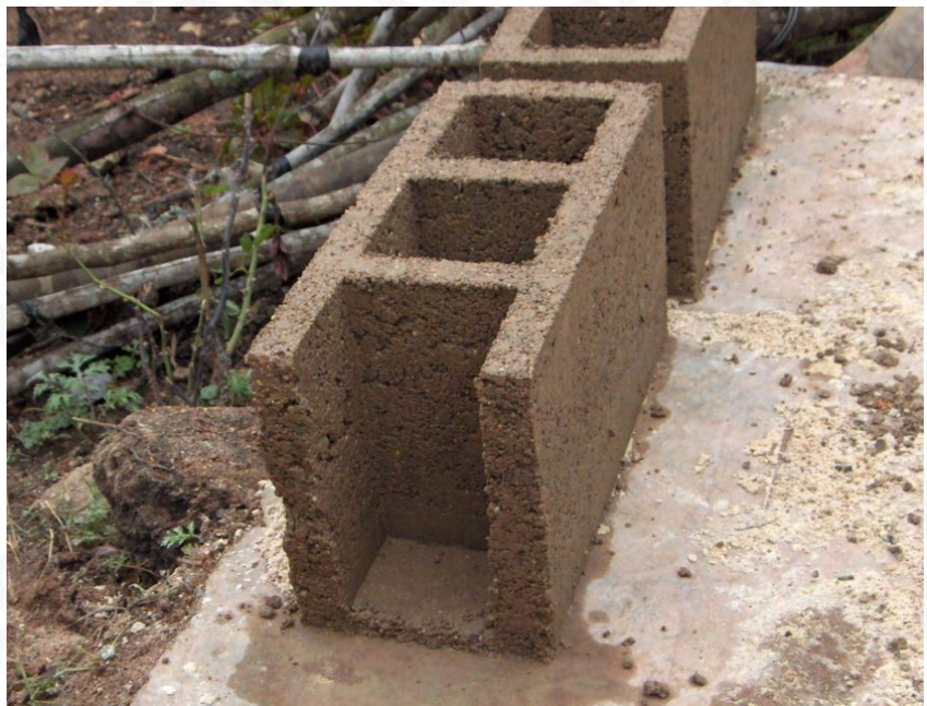
Pieza especial elaborada en fresco
