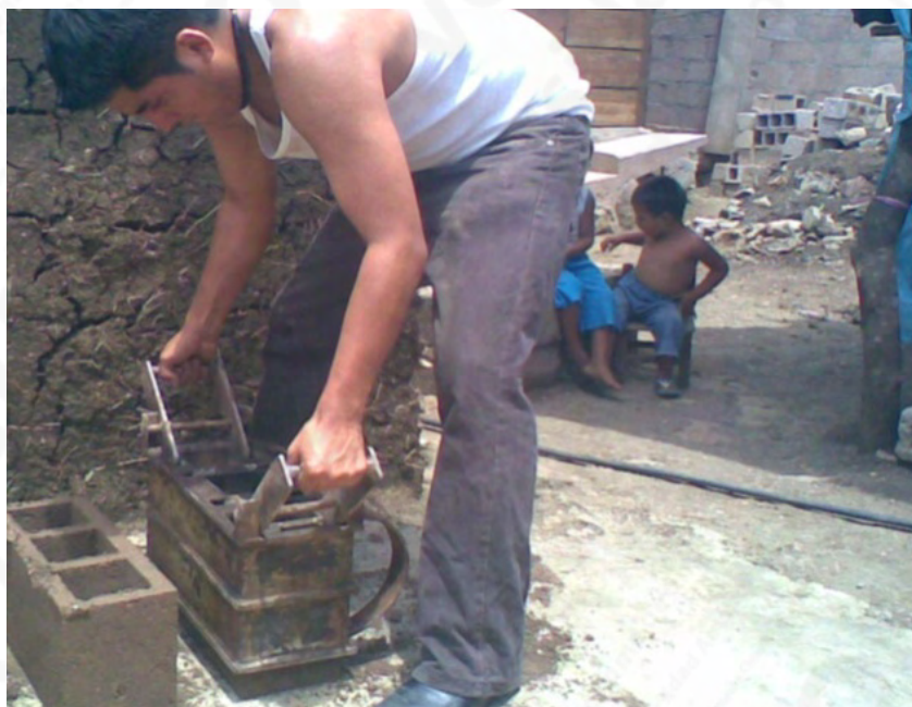
Retiro del molde (1)
