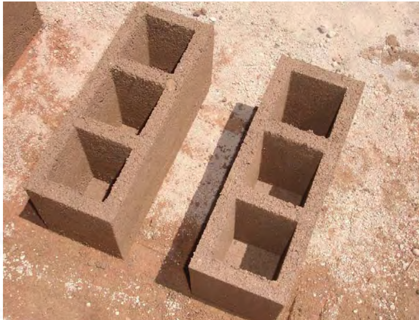
Piezas de block terminadas
