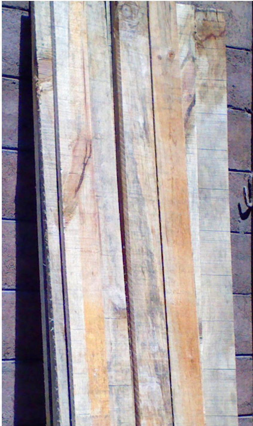
Barros de madera para estructura de cubierta
