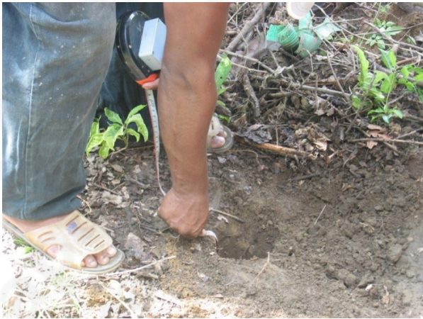
Figura 15. Sondeo de la profundidad del manto freático
