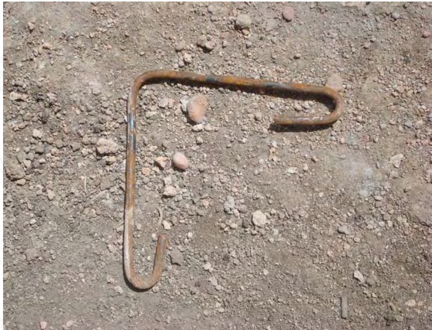
Estribos (Anilletas) para castillos tipo C-L
