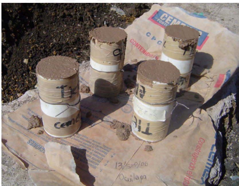
Cilindros de prueba de laboratorio para concreto y mortero
