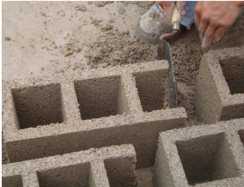
Elaboración de piezas especiales en fresco (Pieza B-2)
